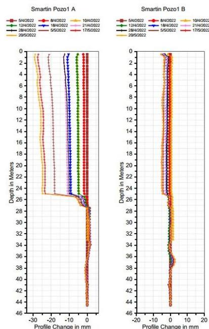
El **inclinómetro** mide la desviación lateral del terreno a distintas profundidades.
